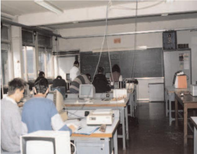
**Salle déjà équipée en réseau en 1987. Les postes de travail sont reliés à un ordinateur central, non visible sur la photo, par des câbles qui passent par le plafond. Chaque poste bénéficie ainsi de l'assembleur pour le microprocesseur Motorola 68000 ou du compilateur C, de la sauvegarde sur disque dur et d'une imprimante commune.**
