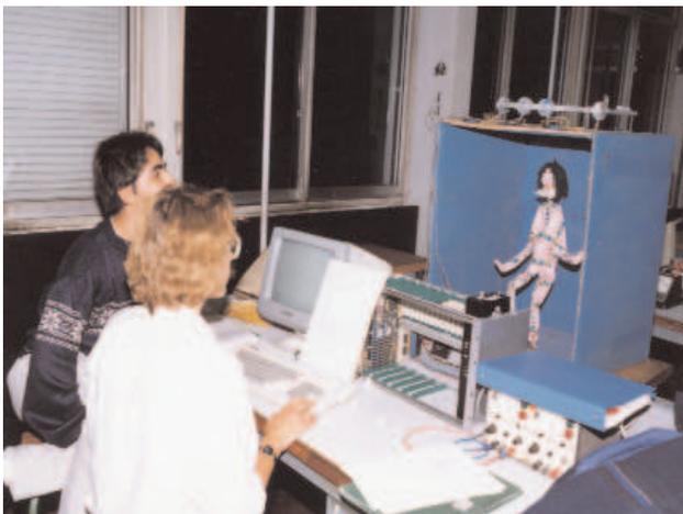
**Commande des bras et des jambes d'une marionnette par des moteurs pas-à-pas situés au-dessus de la caisse bleue. La programmation s'effectue en langage C**
