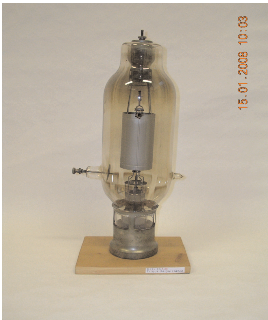
Triode de puissance ayant fait partie de l'émetteur Radio- Club installé à l'Institut de Physique, vraisemblablement entre 1928 et 1939, répertorié sur l'inventaire des anciens
