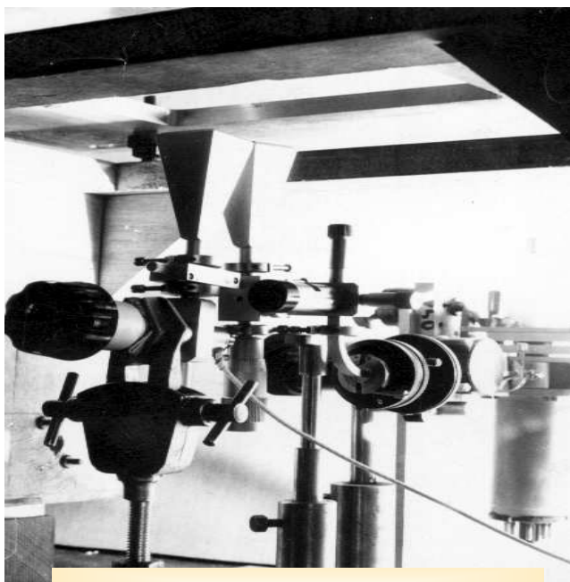
Interféromètre millimétrique (vers 1962)
