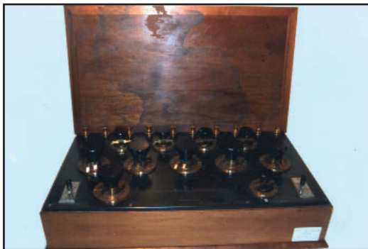
Pont de mesure de résistances (ET 1.20) AOIP, vers 1930 (Le Luxe ! Huit décades de 10 fois 0,0001 à 10 fois 1000 )
