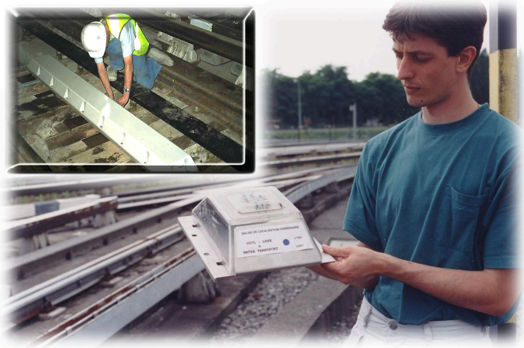
Figure 11 : Balise courte et balise longue METEOR (photo C. Semet - P. Meganck - USTL)
