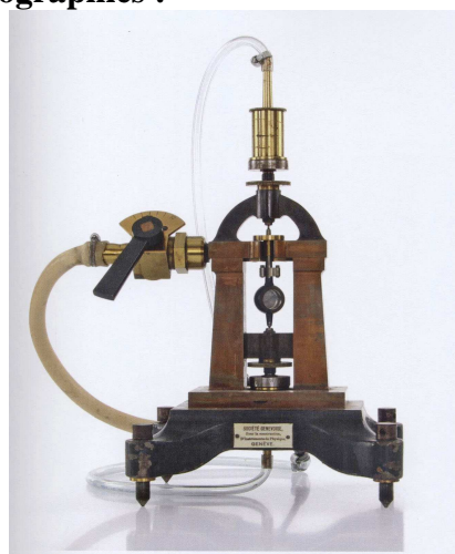
Appareil à miroir tournant de Foucault (collections ASAP)
