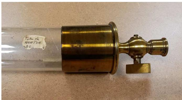
Le tube de Newton (1643-1727) est un instrument permettant de visualiser la chute des corps dans le vide. Il est habituellement utilisé dans une expérience qui met en évidence la loi de Galilée (1564-1642) selon laquelle, tous les corps, en un même lieu, dans le vide, tombent à la même vitesse.
